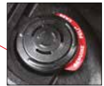
5: AUTOMATISKE TRYKKUTLIKNINGSVENTILER Peli Case har innebygde trykkutligningsventiler som gjør koffertene enkle å åpne ved at de automatisk balanserer det innvendige lufttrykket, uten at støv/vann trenger inn.
