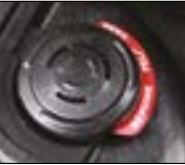
5: AUTOMATISKE TRYKKUTLIKNINGSVENTILER Peli Case har innebygde trykkutlikningsventiler som gjør koffertene enkle å åpne ved at de automatisk balanserer det innvendige lufttrykket, uten at støv/vann trenger inn.
