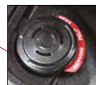
5: AUTOMATISKE TRYKKUTLIKNIINGSVENTILER Peli Case har innebygde trykkutlikningsventiler som gjør koffertene enkle å åpne ved at de automatisk balanserer det innvendige lufttrykket, uten at støv/vann trenger inn.
