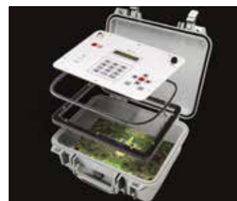
PANELRAMMER brukes til å feste panelplater for elektronisk utstyr.
